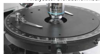
Zentrier- und drehbarer Polarisations-Objektisch
